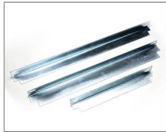
Guide Angle 고하중 장비 지지용으로 사용 허용하중 : 80kg 이내 재질 : STEEL 표면처리 : 도금
