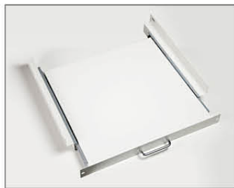
Slide Shelf Open Rack에서 수직 이동 정리 허용하중 : 30kg 재질 : STEEL 표면처리 : 분체도장
